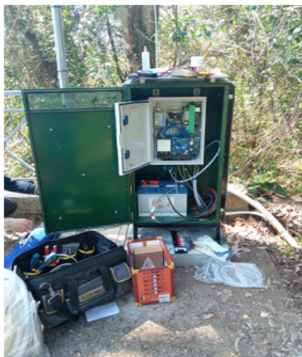
Fig. 7 – Stazione automatica per il monitoraggio delle acque sviluppata da INGV utilizzata per il monitoraggio geochimico in aree vulcaniche (Etna, Vulcano).
